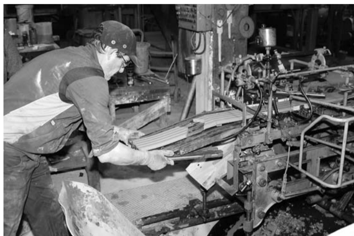
À gauche : mouleuse permettant la fabrication des petites tuiles spéciales. À droite : empilage de tuiles.
